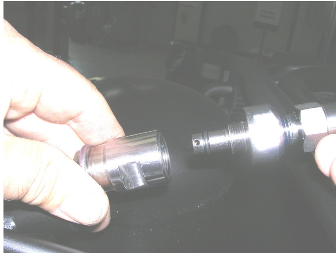
Abbildung 6 – Entfernen des beweglichen Teils des Sicherheitsventils
